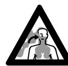
La máquina produce gases de escape tóxicos en cuanto el motor está en marcha. Estos gases pueden ser inodoros e invisibles y pueden contener hidrocarburos y benceno sin quemar. No trabajar nunca con la máquina en locales cerrados o mal ventilados – tampoco con máquinas de catalizador.
